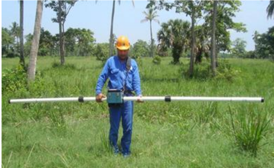
Figura 2.11. Midiendo conductividad del suelo.
