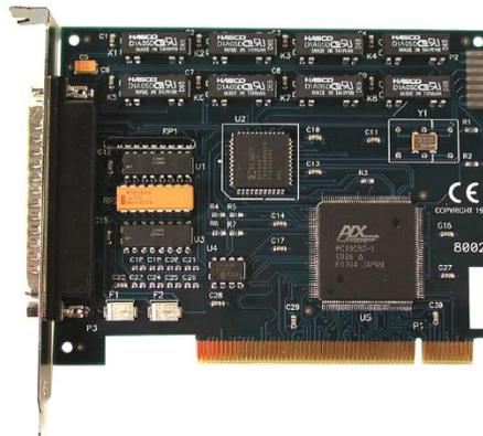
Figura C-1 Tarjeta digital de entrada/salida.
