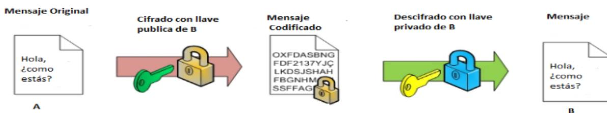
Figura 3.8: Criptografía Asimétrica.
