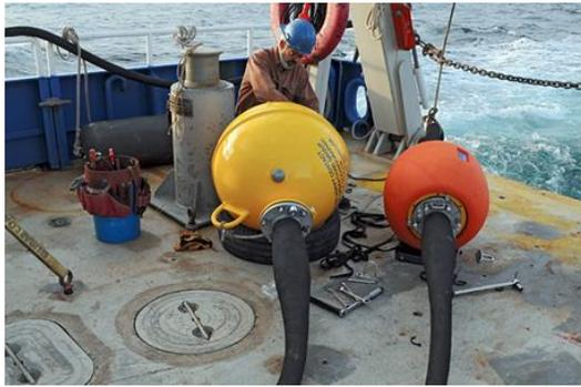
**Fig. 2-8. Boya pequeña (esfera amarilla) conectada a sus instrumentos (esfera naranja) por medio de un cable Gumby hose.**
