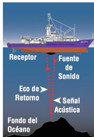
**Fig. 3-2. Funcionamiento de un sonar activo.**
