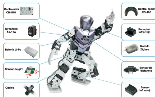
Figura 7.9: Robot humanoide Bioloid Premium Kit (imagen tomada del manual del Bioloid)
