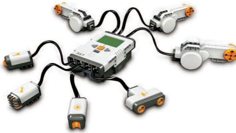
Figura D.3: Lego Mindstorms NXT. La nueva generación del Brick Lego Programable, el NXT LEGO y algunos periféricos externos.
