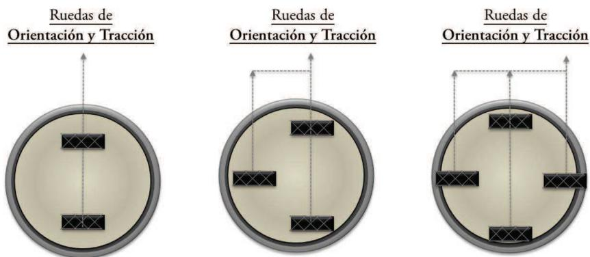
Figura 2.7: Algunos tipos de orientación y mecanismos de tracción de configuración síncrona.
