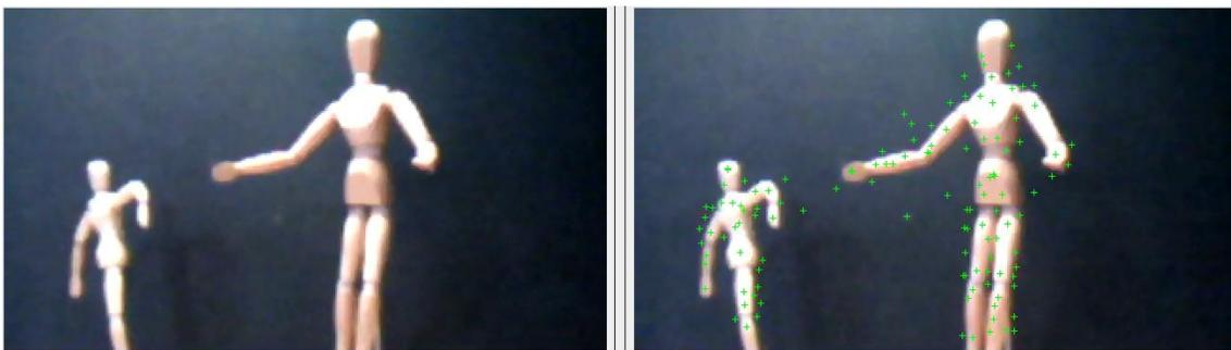
**Figura 4.2.6** Ejemplo de figura de prueba 6 con detección de puntos de interés con la cámara vertical (menor resolución).
