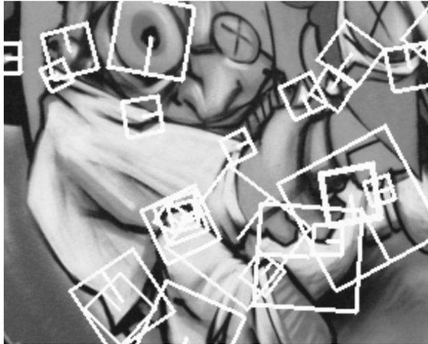
**Figura 3.3.6.1** Ejemplo de las ventanas de descriptores a diferentes escalas.
