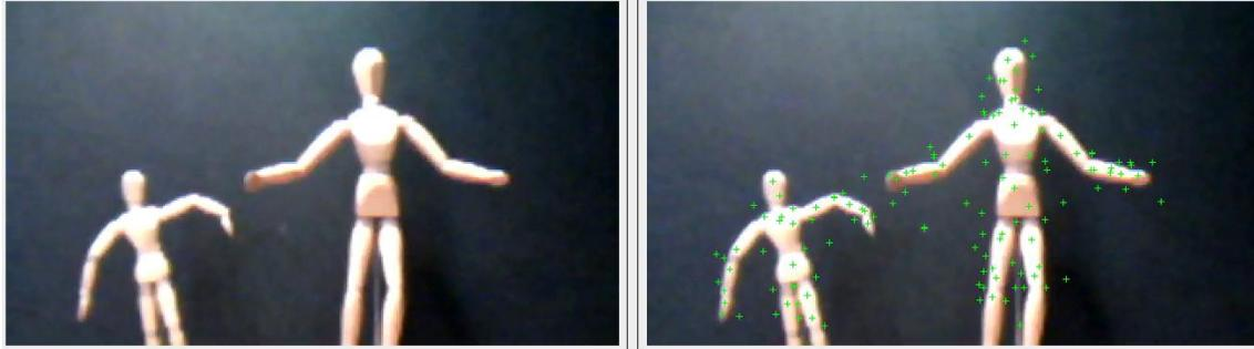
**Figura 4.2.4** Ejemplo de figura de prueba 4 con detección de puntos de interés con la cámara vertical (menor resolución).
