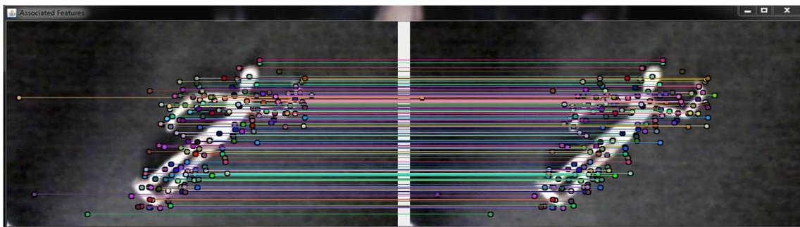
*Figura 4.5.1.2* Comparación de descriptores de puntos de interés para la escena de prueba 2.
