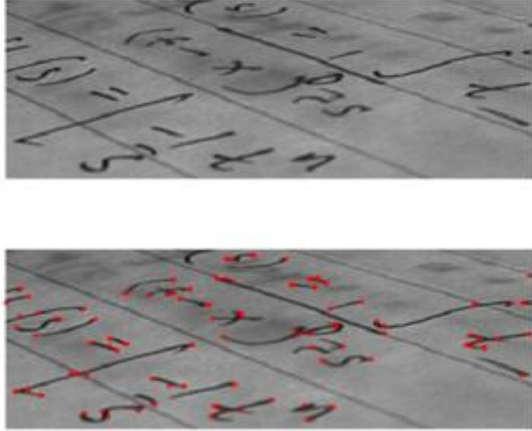
**Figura 3.2.1.1** Ejemplo de localización de puntos de interés (en color rojo) SIFT.
