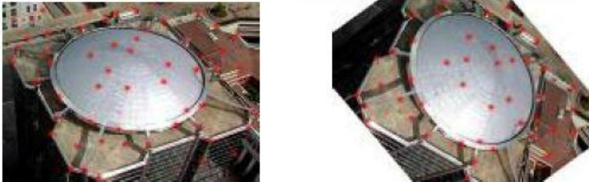
*Figura 2.1.3.1* Ejemplo de identificación de puntos descriptores SIFT.
