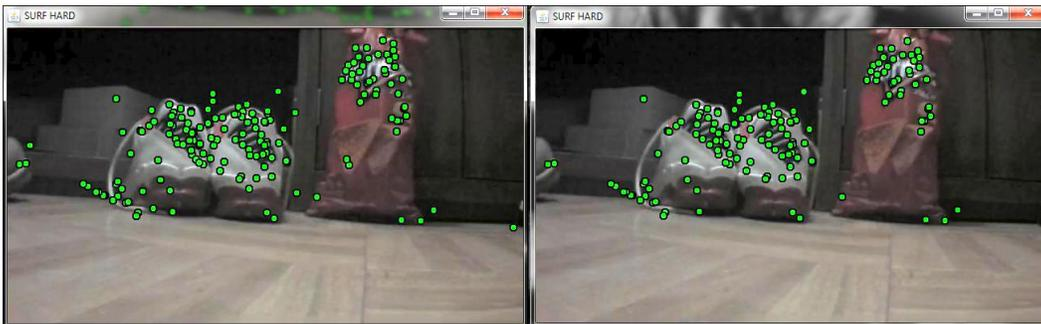
*Figura 4.3.5* Comparativo entre SURF puntos de interés con umbral al 20% y umbral 25%.
