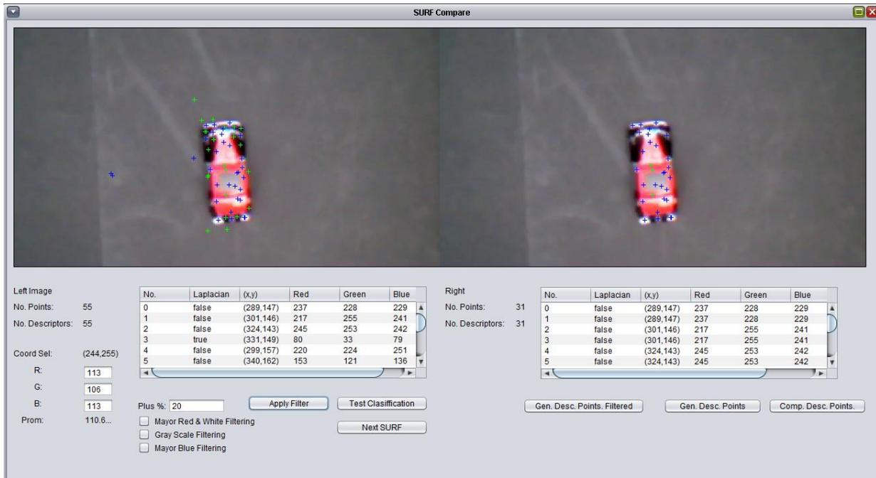
Figura 4.8.1 Filtrado de descriptores de puntos de interés para el “Objeto 2”.
