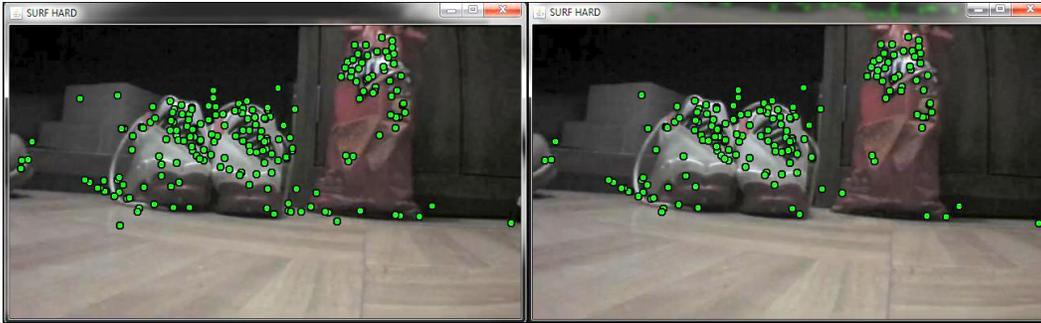
*Figura 4.3.4* Comparativo entre SURF puntos de interés con umbral al 15% y umbral 20%.
