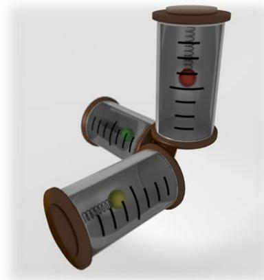
*Figura 3.1: Acelerómetro Triaxial*
