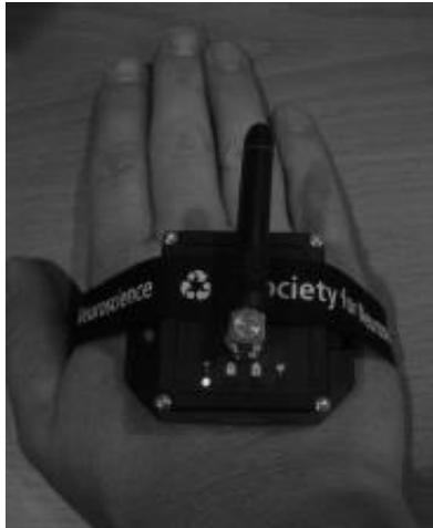
*Figura 2.2: Acelerómetro inalámbrico montado en mano derecha [3]*
