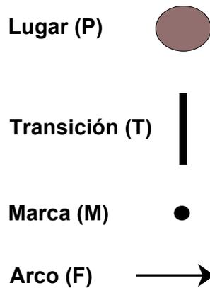
Figura 3.1: Elementos de una red de Petri.
