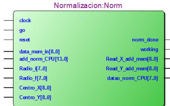
Figura 4.32. Bloque funcional del módulo para la normalización de la imagen en hardware.
