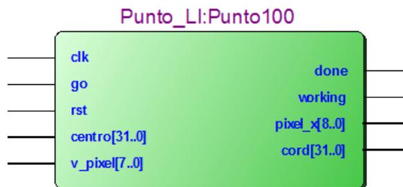
Figura 4.29. Bloque funcional del módulo con el que se obtienen los puntos frontera del iris en la imagen binaria.
