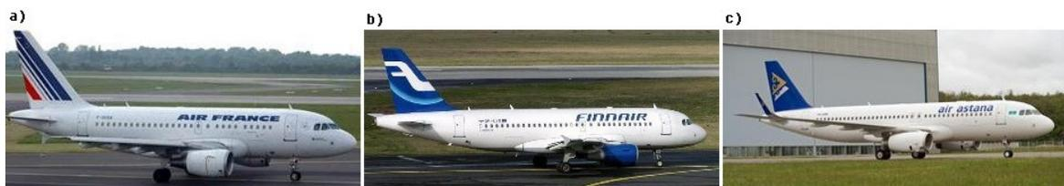
**Fig. 4-7.** Modelos de aeronaves que pertenecen a la clase A320, (a) A318, (b) A319 y (c) A320.
